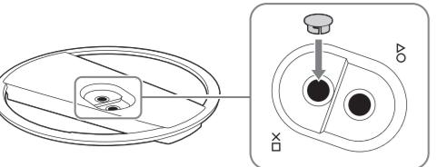
5 Alineie a abertura do parafuso (indicada com  $\Delta$ ) no suporte com a abertura do parafuso do console e, em seguida, fixe-o com o parafuso de montagem usando sua mão.
